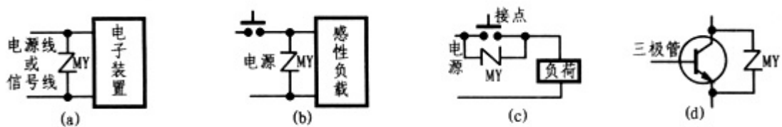
图 1 采用压敏电阻的防护连接
